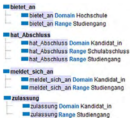
Abbildung 10: Spezifikation von Beziehungen zwischen Klassen in Protege
