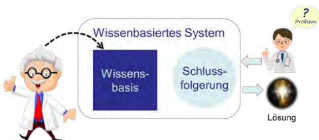
Abbildung 2: Aufbau eines wissensbasierten Systems
